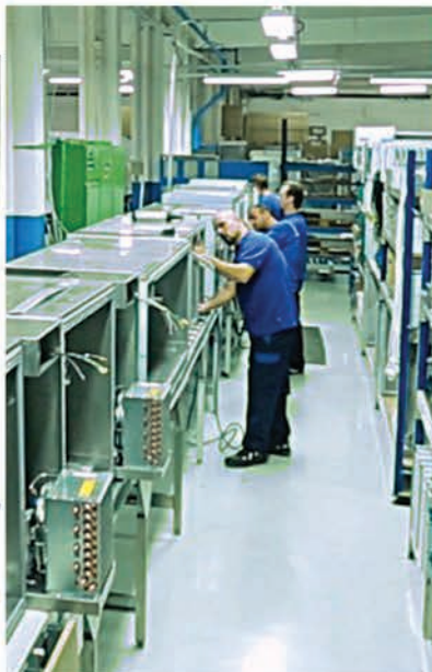
Pianowanie / Montaż Foam insulation / Assembling
