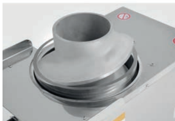
Umożliwia zaokrąglanie porcji ciasta w przedziale już od 40 g do aż 650 g
