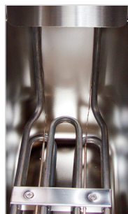
bez pokrywy ochronnej grzałek i kapilar
